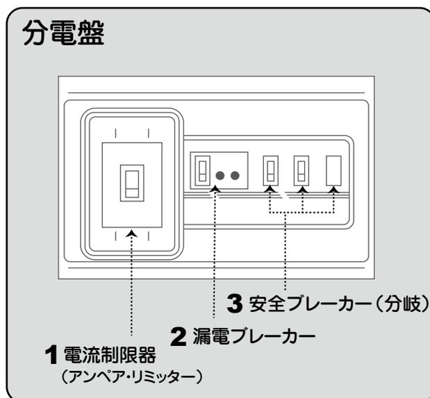
※電流制限器がない場合、漏電ブレーカーから押し上げてください。
